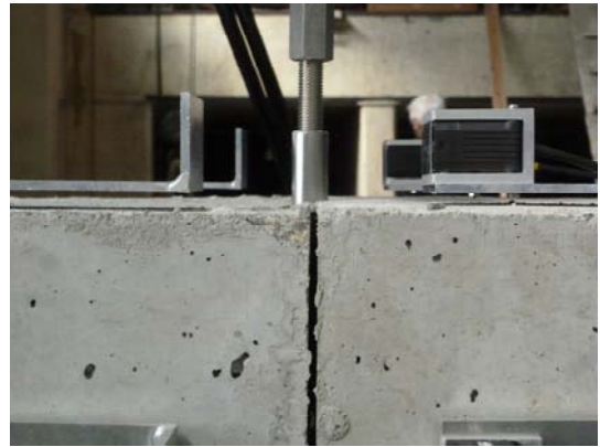
写真 6 ひび割れ発生状況
