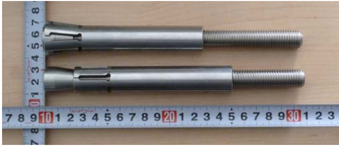
写真 5 あと施工アンカーの全景
